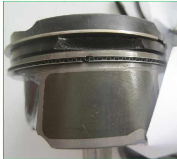
Deto-knock! 机械破坏
