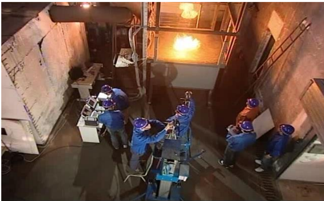
池火向火旋风转变实验, N. Liu
