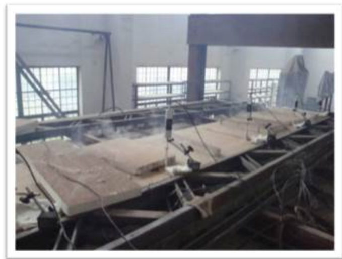
顶格板火灾测试实验
